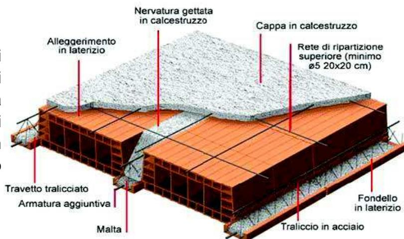
La copertura sarà del tipo piana per il condominio realizzata in latero-cemento coibentata, e composta da pannelli di latero-cemento armato completi di nervature e soletta collaborante idoneamente calcolata. Sulla copertura sarà realizzato idoneo massetto pendenzato e materiale coibente come previsto dalla relazione del termotecnico (Legge 10/91), inoltre, è prevista l'impermeabilizzazione con guaina in bitume tinteggiata di colore
